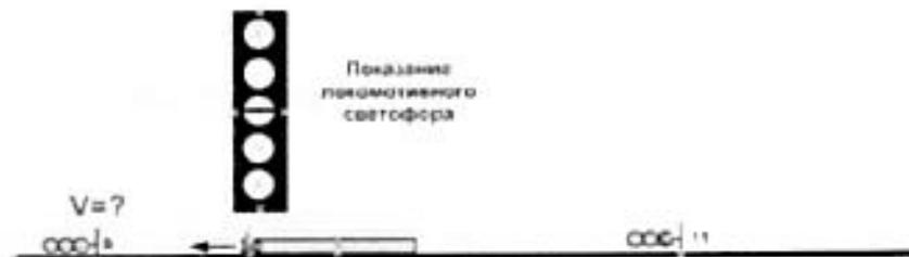
13. С какой максимальной скоростью может следовать поезд из позиции 3, после проследования проходного светофора 7 с запрещающим показанием до проходного светофора 5?
